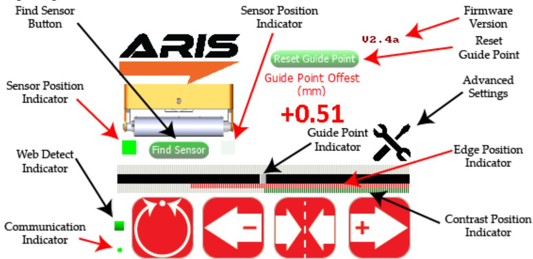
Fig. 25: SCU5 Operator Interface
